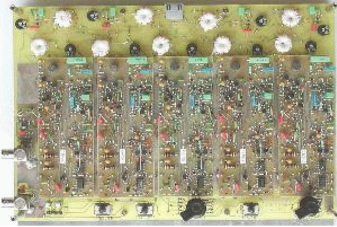
**Fig 3 : dispositif pour la mesure de  $Z_S$  et  $Y_S$**
